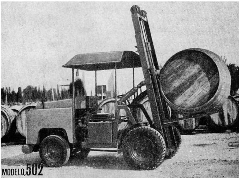
Modelo 500 (con volteador) y del 502 (cargados con bocoyes de madera):
